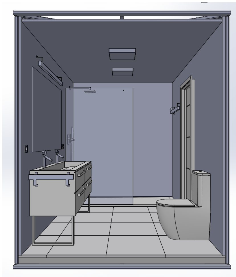
Vista del baño modular prefabricado desde un panel lateral
